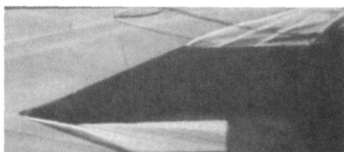
图 10 R_{ic} = 1.19 模型进气道纹影照片
